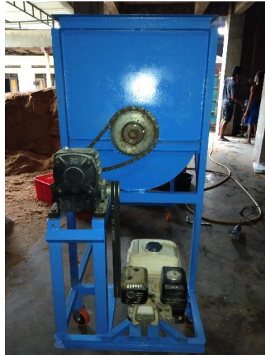
Gambar 11 Mekanisme Alat Pengaduk Media Tanam Jamur
