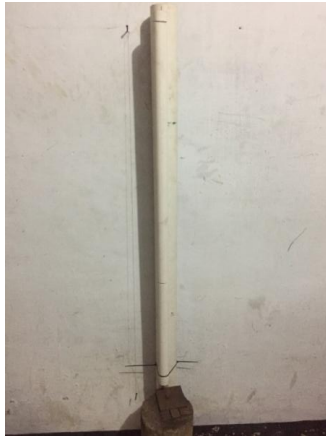
Gambar 9. alat uji bonding yang digunakan untuk pengujian kekuatan rekat hasil pelapisan kaca bekas pada permukaan baja karbon rendah
