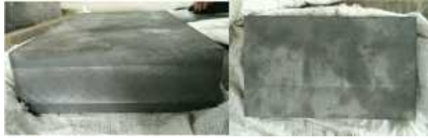
Gambar 14 Hasil blok material FCD bagian cetakan bawah
