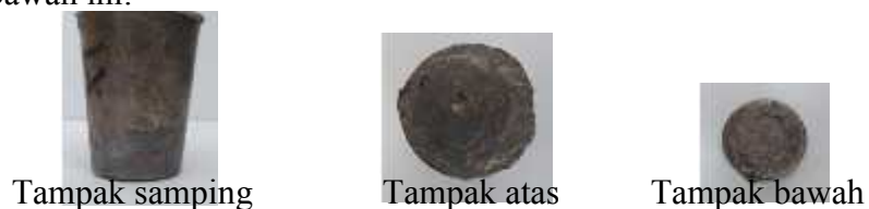
Gambar 23 Hasil jadi produk cetakan permanen
