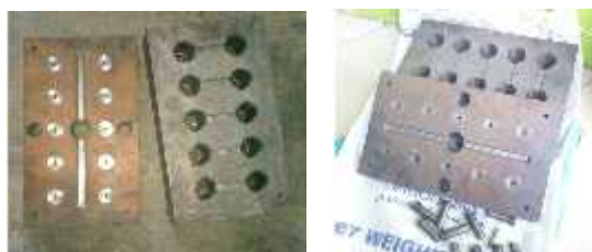
Gambar 18 Hasil proses pemesinan (Cetakan Permanen)
