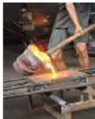
Gambar 21 Penuangan logam cair ke cetakan.
