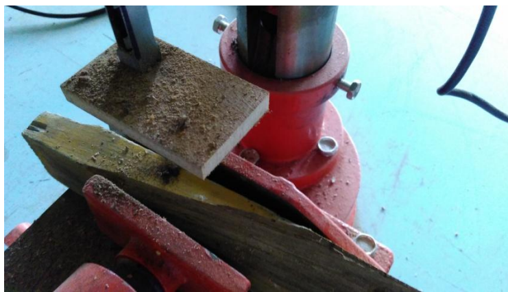
Gambar 5 Permasalahan pencekaman pada mesin Mortiser
