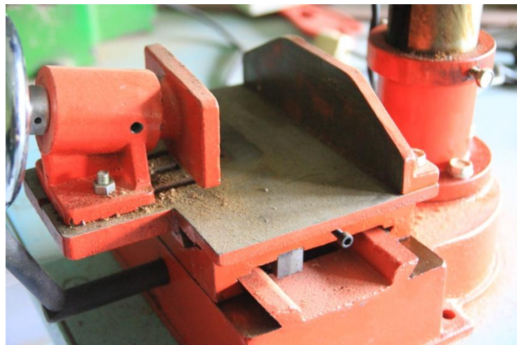
Gambar 2 Sistem pencekaman pada mesin Mortier
