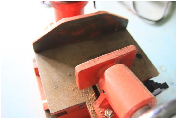
Gambar 1 Sistem pencekaman pada mesin Mortiser
