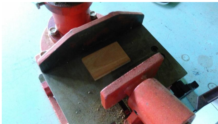
Gambar 3 Perbandingan ukuran benda kerja dengan pencekam mesin Mortiser
