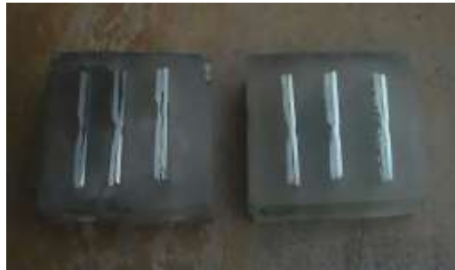
Gambar 6. Spesimen setelah dipotong dan di mounting
