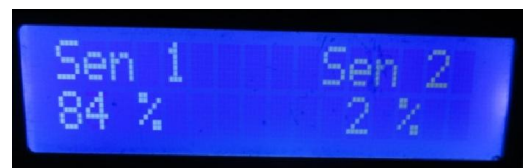
Gambar 12. Terjadi kebocoran di area sensor dalam.
