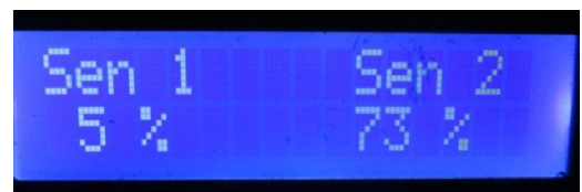
Gambar 13. Terjadi kebocoran di area sensor luar.
