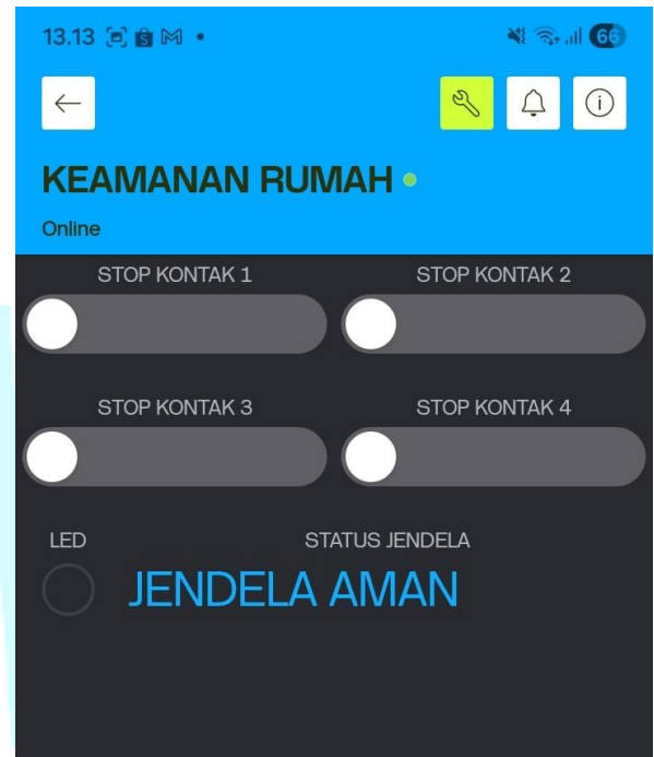
(b) Stop kontak 1-4 kondisi OFF pada aplikasi Blynk
