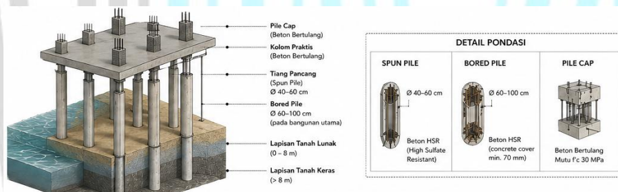
Struktur Tiang Pancang dan Struktur Bored Pile
