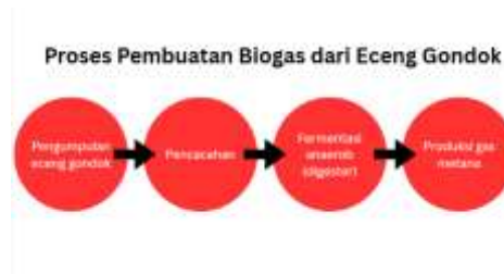
Gambar 9. Proses Pembuatan Biogas dari Eceng Gondok
