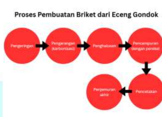
Gambar 11. Proses Pembuatan Briket dari Eceng Gondok
