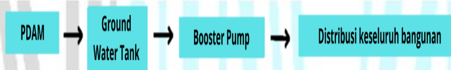
Gambar 12. Skema Sistem utilitas air Sumber: Analisa Penulis, 2026
