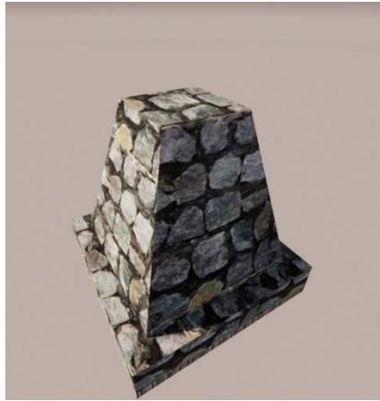
Gambar 48. Pondasi batu kali Sumber : sketchup, 2026
