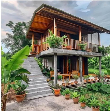
Gambar 4. Rumah 2 lantai Bawah Beton Atas Kayu Sumber : (Khairi, 2025)
