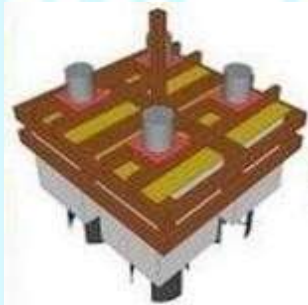
Gambar 3. Guidemasts dan Cincin Peluncur (Sumber: Wijanarka, 2019)
