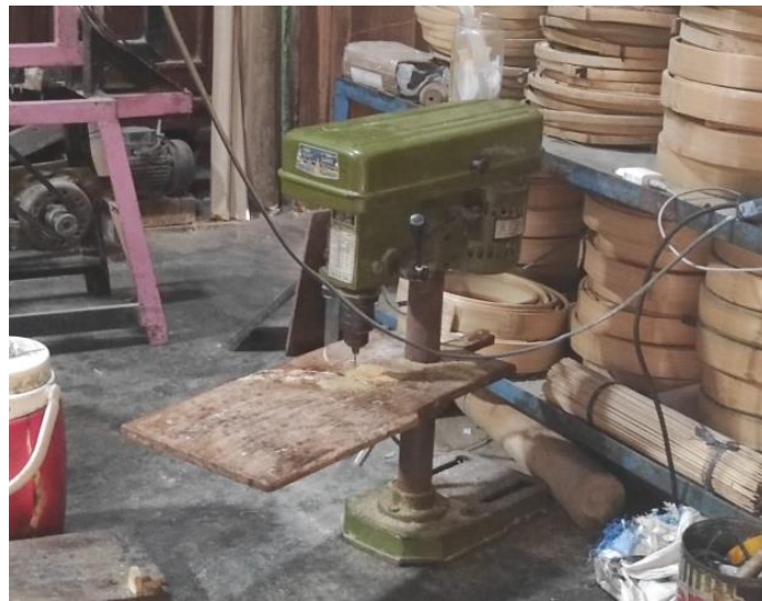
Gambar 2.4 Proses Pelubangan Bambu
