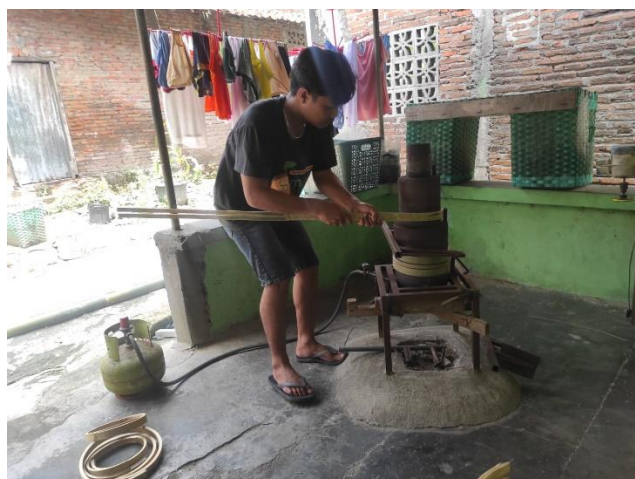
Gambar 2.3 Proses Melengkungkan Bambu
