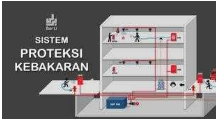
Gambar 4. 30 Sistem Proteksi Kebakaran
