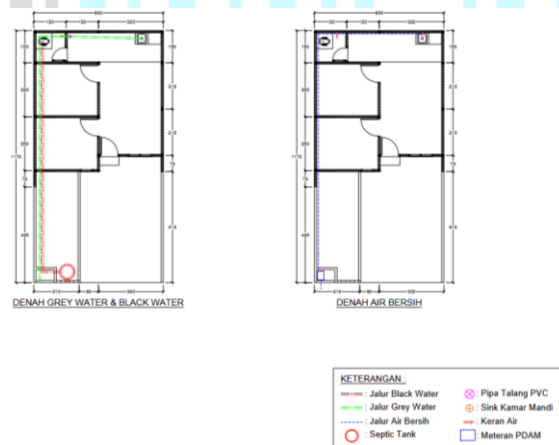
Gambar 14. Contoh Saluran Sanitasi Hunian Sederhana
