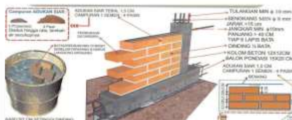
Gambar 14. Konsep dinding dan kolom
