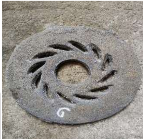
Gambar 5. Hasil pengecoran sebelum machining
