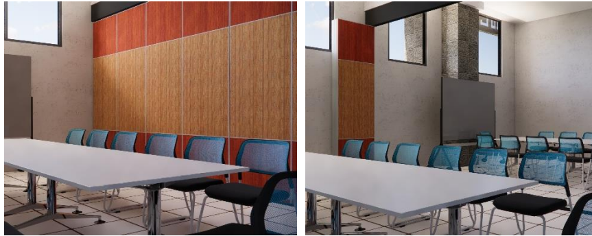
Gambar 123. Konsep Partisi Lipat Tertutup (Kiri) dan Terbuka (Kanan)
