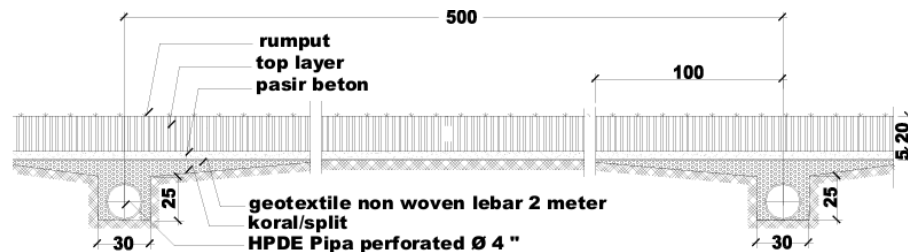
Gambar 3. Potongan Sistem Drainase Lapangan
