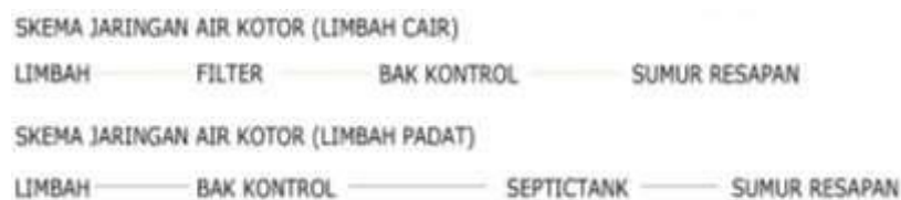
Gambar 10. Skema jaringan Air Kotor Sumber : Dokumen Penulis
