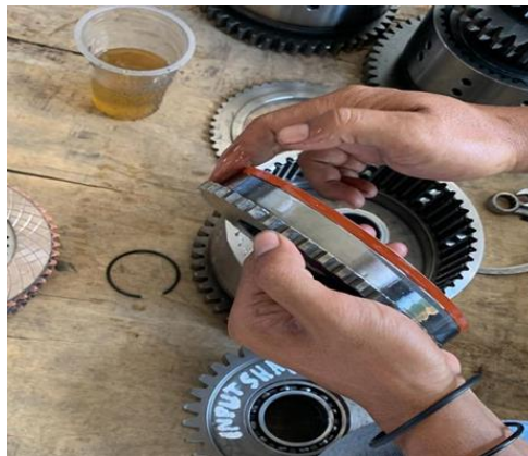
Gambar 9 Penggantian Seal dan Ring
