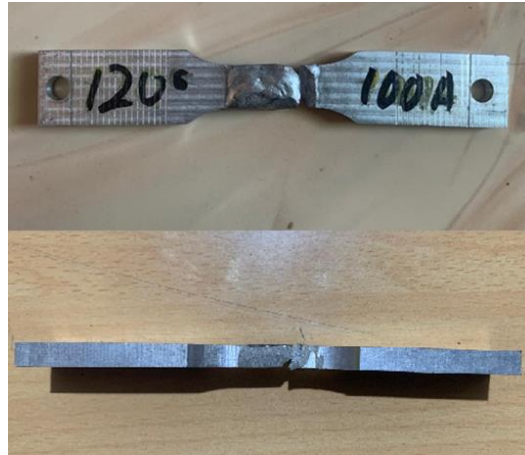
Gambar 6. Bagian patahan arus AC 120° 100A
