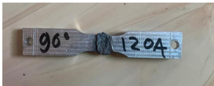
Gambar 14. Hasil patahan arus DCEN 90° 120A
