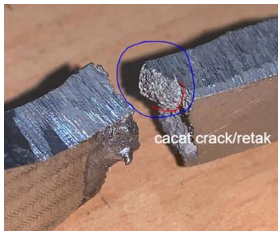
Gambar 10. Cacat pengelasan variasi arus AC 120° 120A
