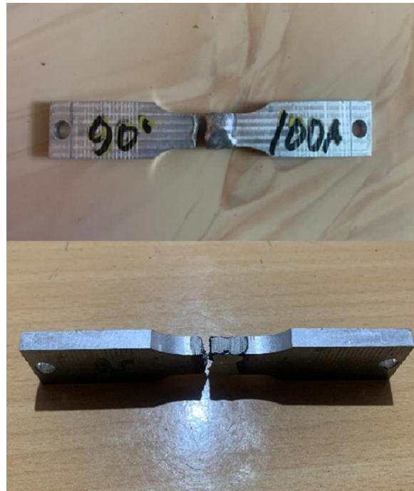
Gambar 2. Bagian patahan arus AC 90° 100A
