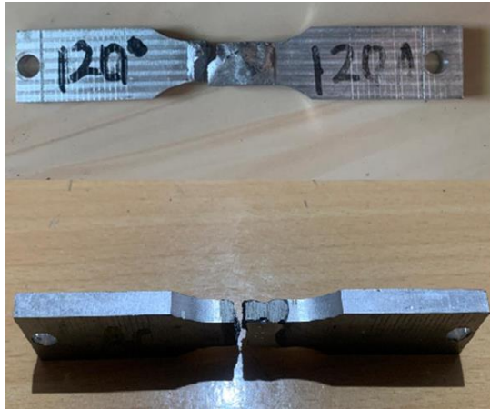
Gambar 8. Hasil patahan arus AC 120° 120A
