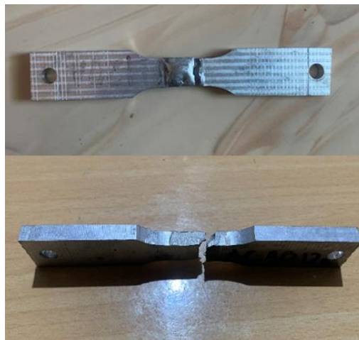
Gambar 4. Bagian patahan arus AC 90° 120A
