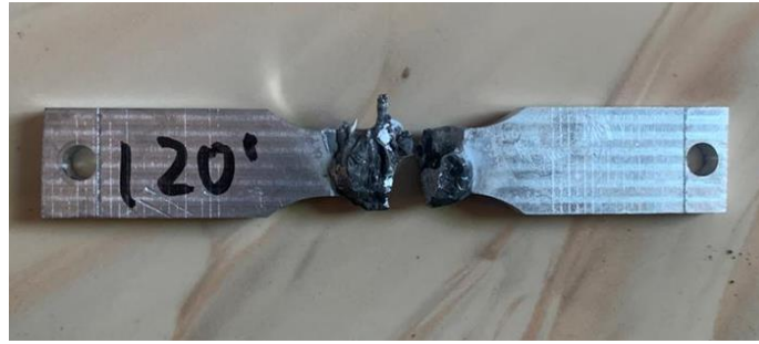
Gambar 18. Hasil patahan arus DCEN 120° 120A
