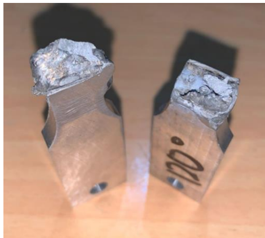
Gambar 17. Hasil patahan arus DCEN 120° 100A
