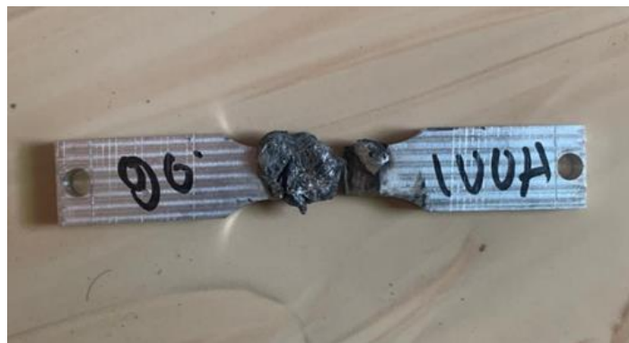
Gambar 11. Bagian patahan arus DCEN 90° 100A
