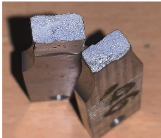
Gambar 3. Hasil patahan arus AC 90° 100A
