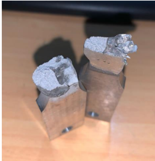
Gambar 19. Hasil patahan arus DCEN 120° 120A
