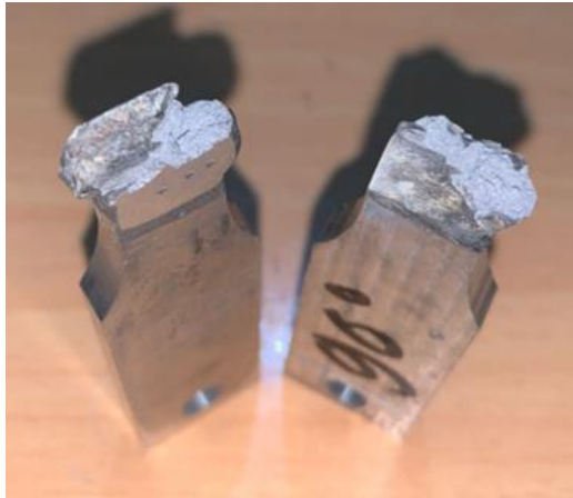
Gambar 15. Hasil patahan arus DCEN 90° 120A
