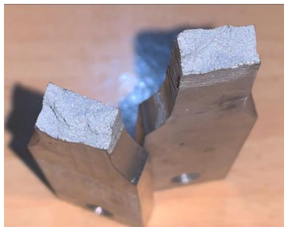
Gambar 5. Hasil patahan arus AC 90° 120A
