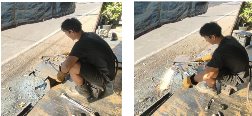
Gambar 2. Proses Pemotongan Sebelum dan Sesudah menggunakan Alat bantu /meja potong
