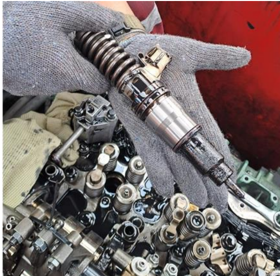
Gambar 3.1. 9 Mencabut Injector dari Cylinder Head
