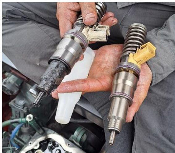
Gambar 3. 1.11 Mengganti Komponen Injector
