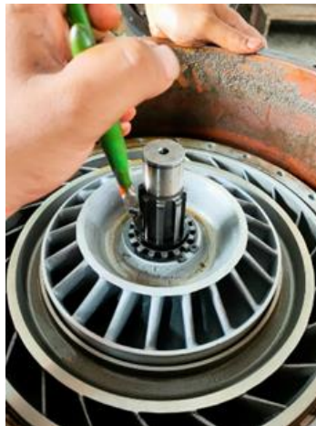
Gambar 15 Pemasangan Snap Ring
