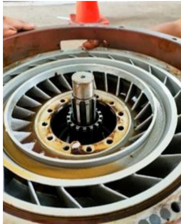
Gambar 8 Membuka Pump Impeller
