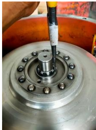
Gambar 17 Pemasangan Snap Ring
