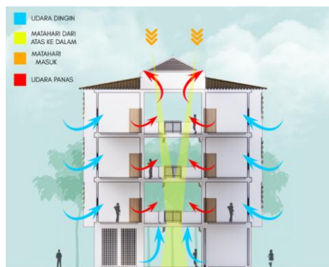
Gambar 6. Penerapan Sistem Cross Ventilation pada Bangunan
