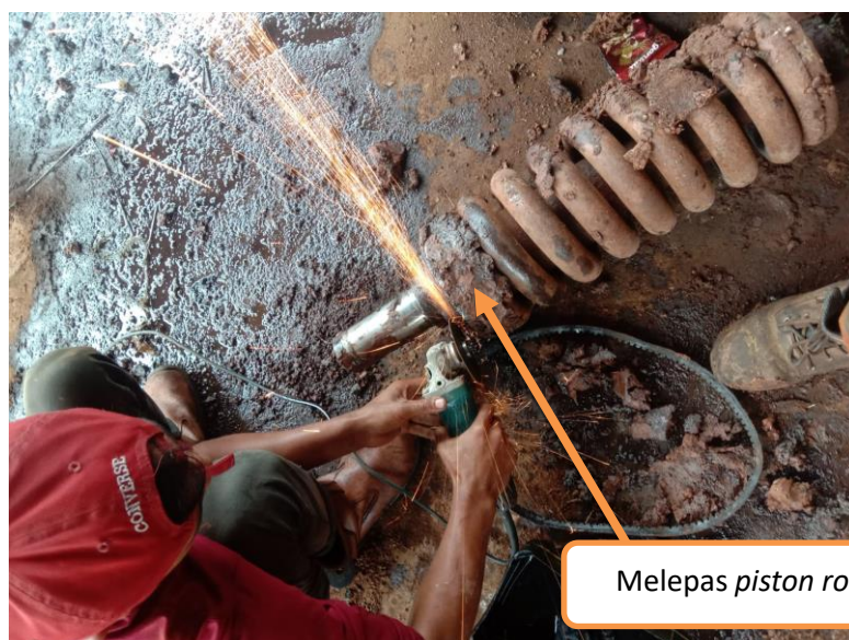
Gambar 8 Melepas piston rod dari cylinder rod
