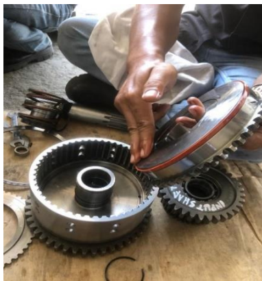
Gambar 3.4 Penggantian Seal dan Lock Seal Ring
