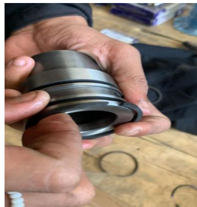
Gambar 3.4 Penggantian Seal dan Lock Seal Ring
