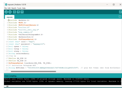
Gambar 6. Tampilan upload script berhasil pada program ESP32-CAM
