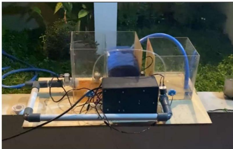
Gambar 6. Pengujian sistem filtrasi
