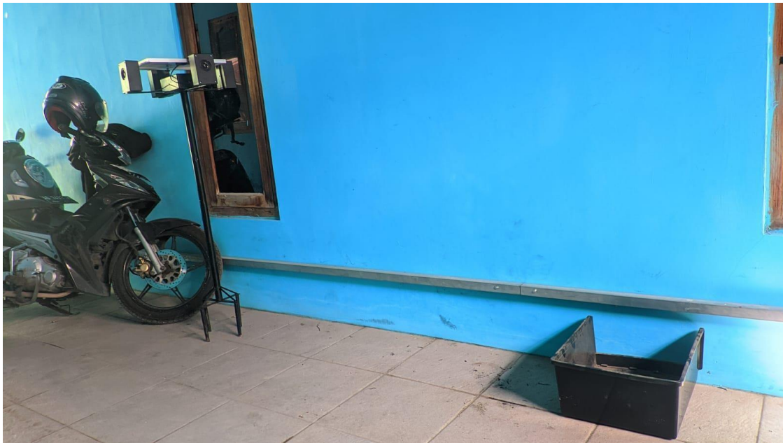
Gambar 8. Pengujian sistem dengan audio frekuensi 25KHz dengan jarak 1 meter
