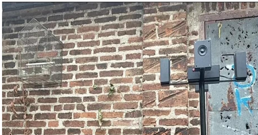
Gambar 9. Pengujian sistem dengan audio frekuensi 1,9KHz dengan jarak 3 meter
