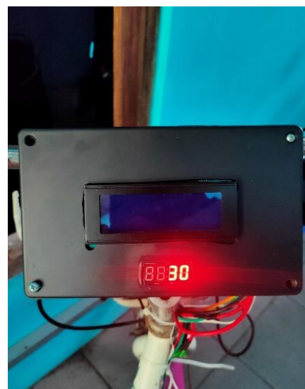
Gambar 7d. Tampilan 7-Segment perangkat Slave
