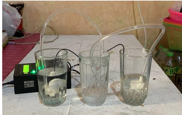
Gambar 13. Uji Kendali Pompa DC
