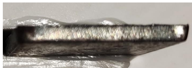
Gambar 23 Permukaan specimen variasi diameter nozzle 1,5 mm pada titik 3
