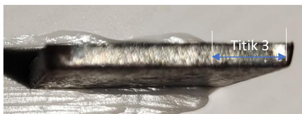
Gambar 26 Permukaan specimen variasi diameter nozzle 1,7 mm pada titik 3
