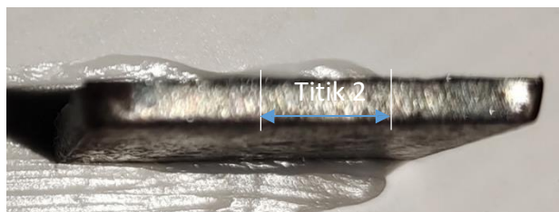
Gambar 25 Permukaan specimen variasi diameter nozzle 1,7 mm pada titik 2
