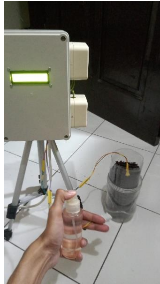
Gambar 12. Pengujian dengan penyemprot air
