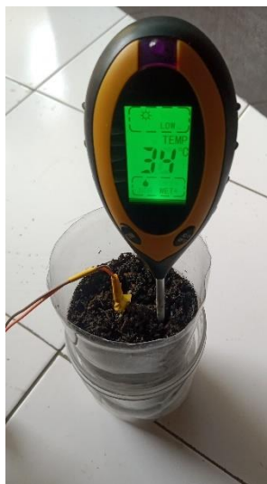
Gambar 10. Pengambilan sampel kelembapan tanah
