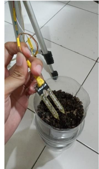
Gambar 13. Pengujian dengan tanah basah
