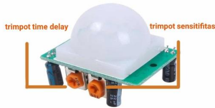
Gambar 3. Trimpot time delay dan Trimpot sensitifitas pada sensor PIR
