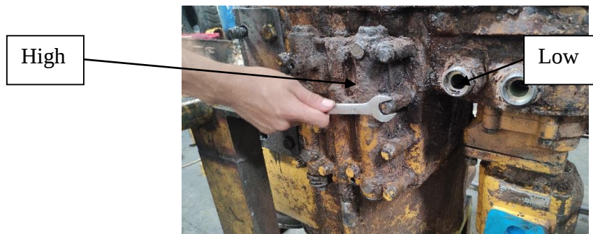
Gambar 2 Proses pemeriksaan level oli transmisi
