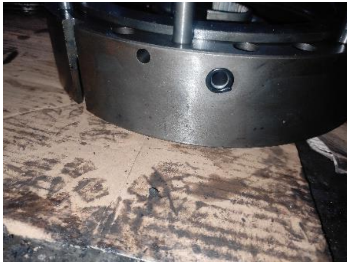
Gambar 7 Seal Ring yang mengalami rusak berupa sobekan pada bagian sisinya
