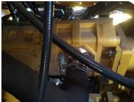
Gambar 3 Proses pemeriksaan kondisi selang hose
