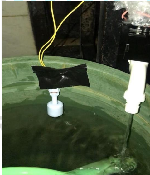
Gambar 5. Tampilan water level switch dan motor servo.
