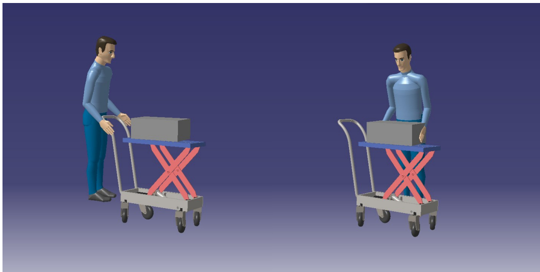
Gambar 4. Postur kerja pekerjaan B dengan scissor trolley
