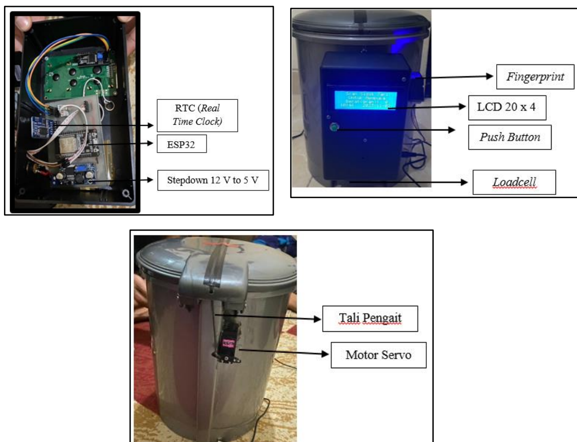
Gambar 7. Konstruksi Tempat Sampah
