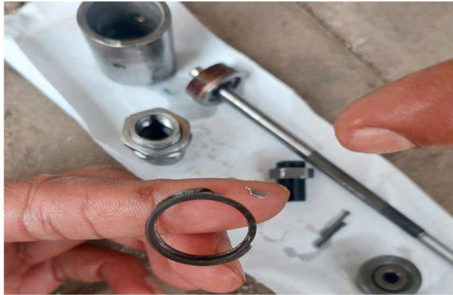
Gambar 6. Penampakan O Ring yang Menyumbat Adjuster Main Pump
