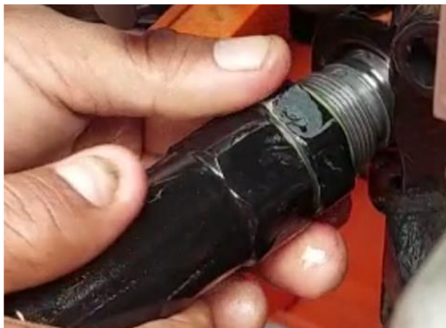
Gambar 8. Proses Pemasangan Adjuster Main Pump Yang Baru
