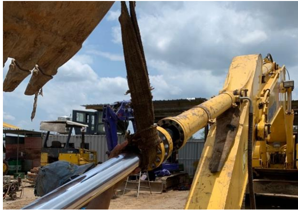
Gambar 13. Pemasangan Piston rod
