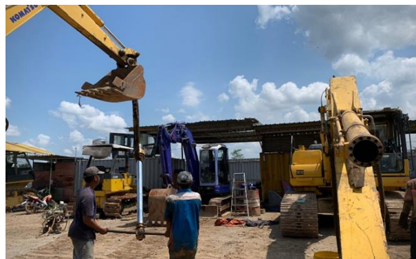
Gambar 7. Melepas piston rod
