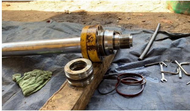
Gambar 9. Melepas O-ring dan seal
