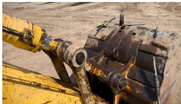
Gambar 16. Pemasangan pin pada As
