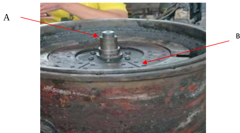
Gambar 29 pemasangan porors shaft (A) dan plat kopling kedua (B)
