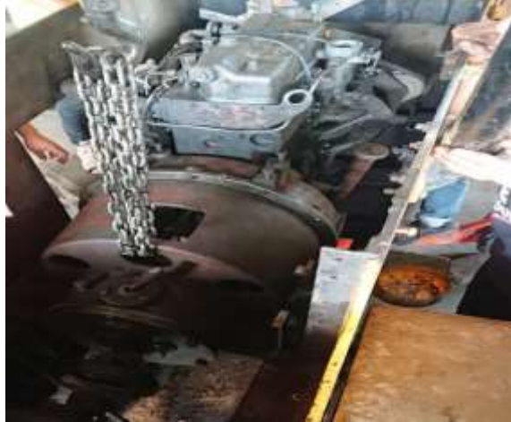
Gambar 32 pengangkatan dan pemasangan main clutch pada chasis dan perakitan bagian kap mesin dan kabin pengendali
