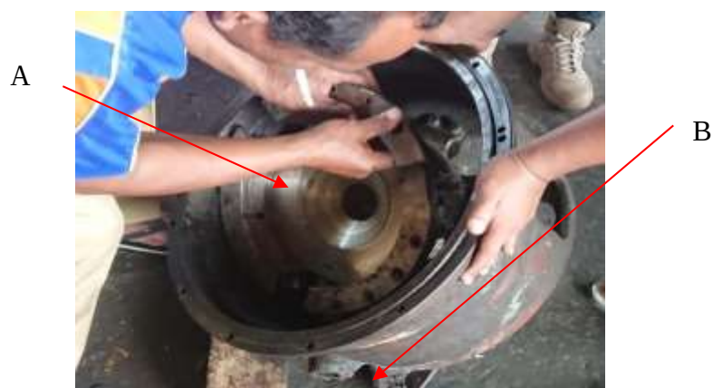
Gambar 27 Pemasangan bingkai dan bantalan pengendali main clutch
