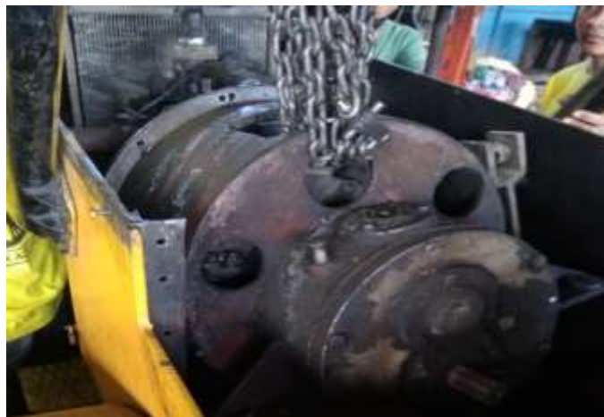
Gambar 8. Pengangkatan rumah kopling dengan crane
