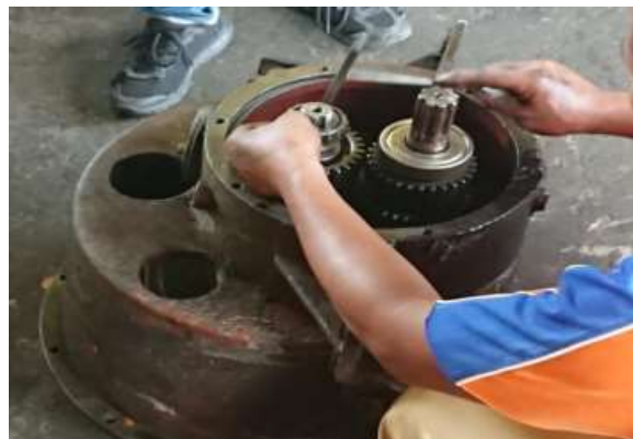
Gambar 31 Pemasangan bantalan gelinding, gear gigi transmisi, roda gigi pembalik, shaft propeller dan cover tranmisi pada main clutch .
