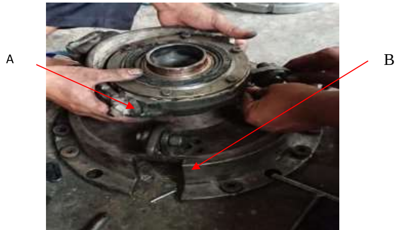
Gambar 26 pemasangan lever penghubung rumah bantalan pengendali, bingkai main clutch (B)
