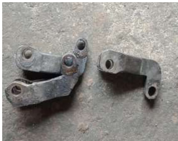
Gambar 22 Lever yang rusak
