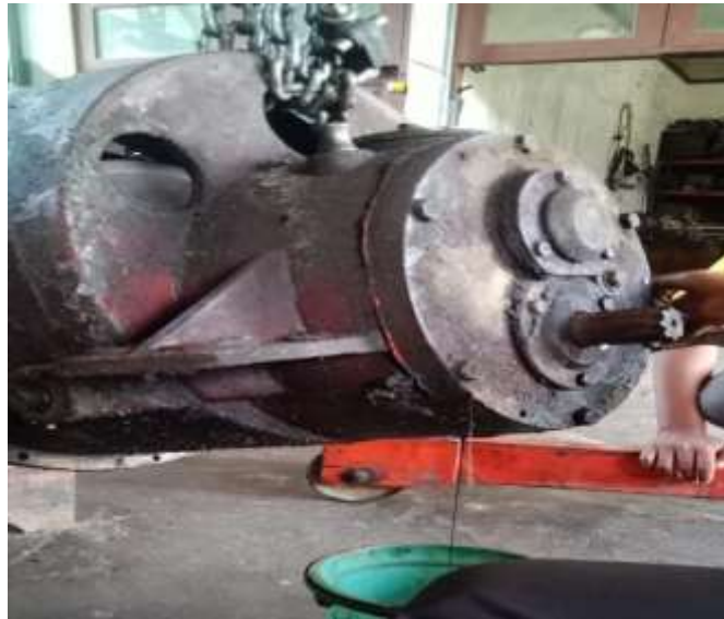
Gambar 9. Mengeluarkan oli roda gigi transmisi
