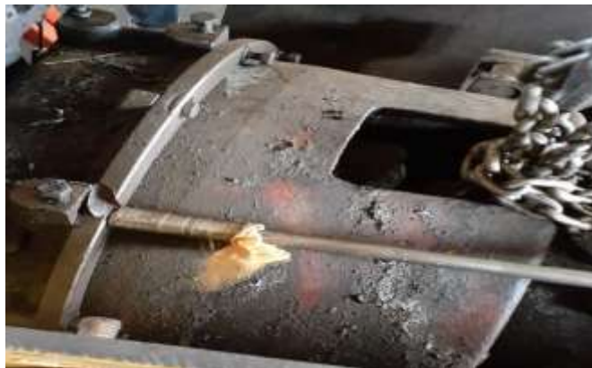
Gambar 6 Pelepasan bolt penghubung main clutch dengan engine
