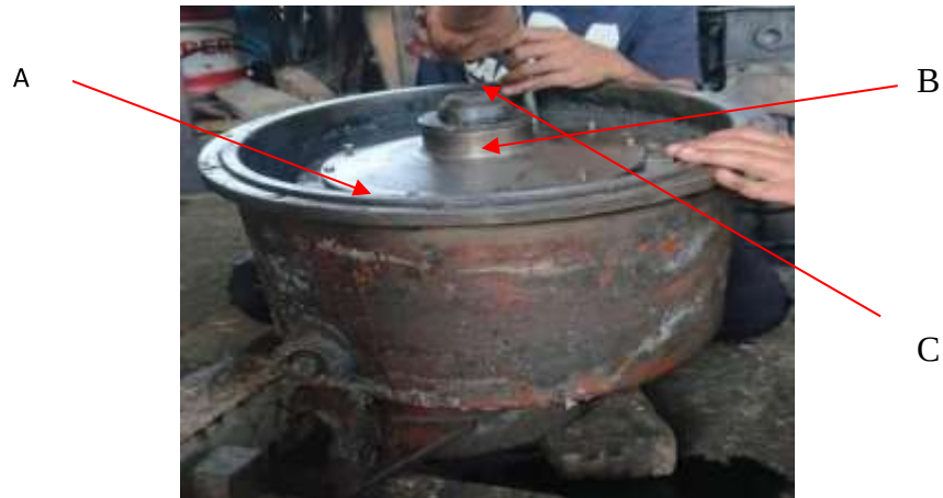
Gambar 30 Pemasangan plat penahan (A), baut poros shaft (B) dan cover baut poros (C) pada main clutch
