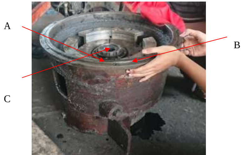
Gambar 28 pemasangan poros shaft pertama (A), plat kopling gesek dan gesek (B), pengelingan lining (C)
