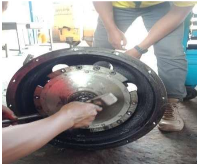
Gambar 11 Melepas nut poros piringan menggunakan chisel dan hammer
