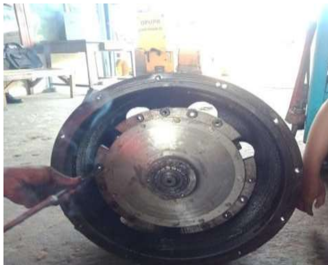
Gambar 12. Melepas bolt piringan penahan dengan bingkai rumah kopling
