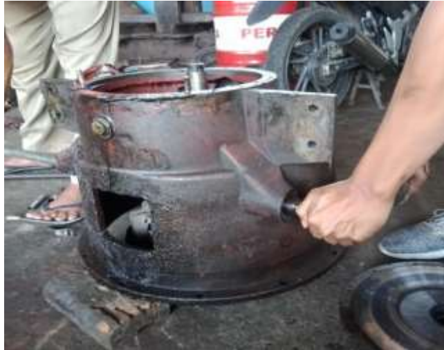
Gambar 17. Melepaskan control linkage yang terhubung dengan bantalan pengendali pada rumah kopling
