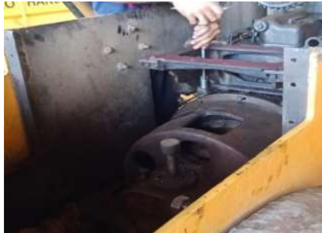
Gambar 5 Pelepasan bolt main clutch dengan chasis
