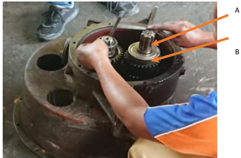
Gambar 15. Melepas cover , gear , poros shaft dan bantalan glinding pada rumah kopling
