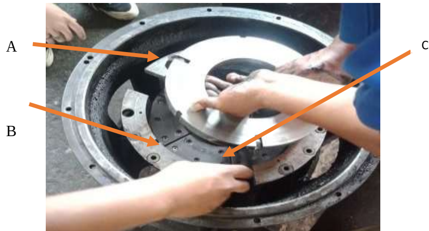
Gambar 14 Pelepasan Pelat Kopling Gesek dan Piringan Kopling Kedua
