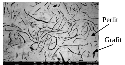
Gambar 4 Foto Struktur mikro besi cor kelabu 3,067% wt Si
