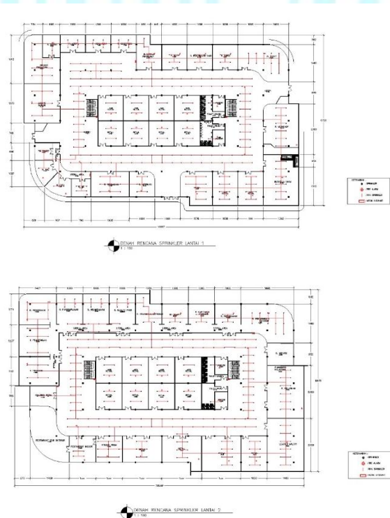
Gambar 20. Sistem Pemadam Kebakaran Sumber : Olahan Penulis, 2023
