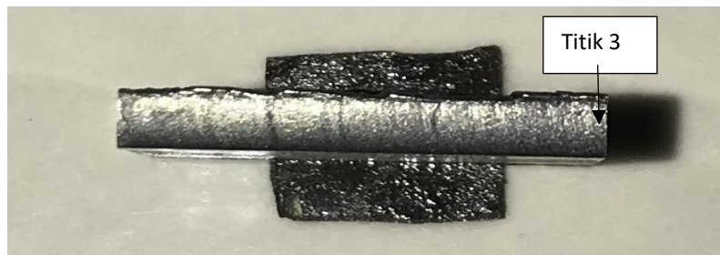
Gambar 38. Spesimen Variasi Kecepatan Gerak Torch 2500 mm/min
