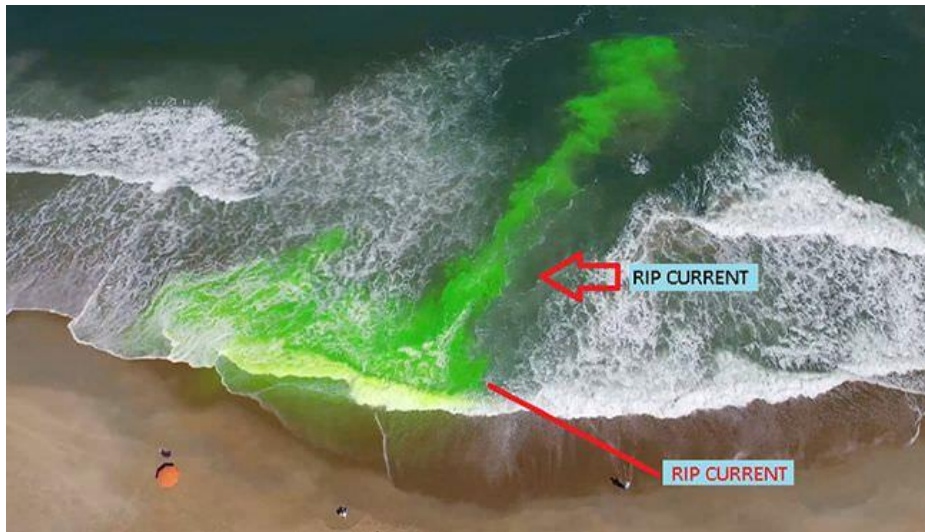
Gambar 1.5 Contoh Penggunaan Fluorescentdye untuk Identifikasi Arus retas https://radarbali.jawapos.com/
