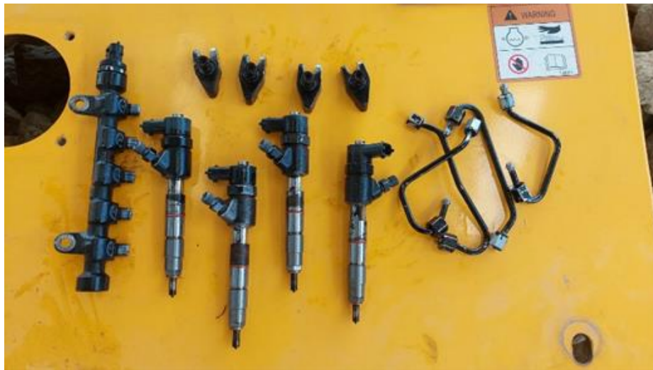
Gambar 4 Common Rail dan Injector yang telah dicuci dan dibersihkan
