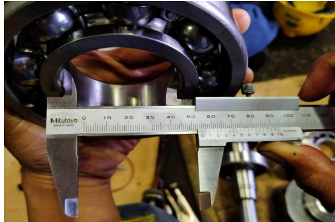
Gambar 4. Pengukuran diameter dalam Bearing 2
