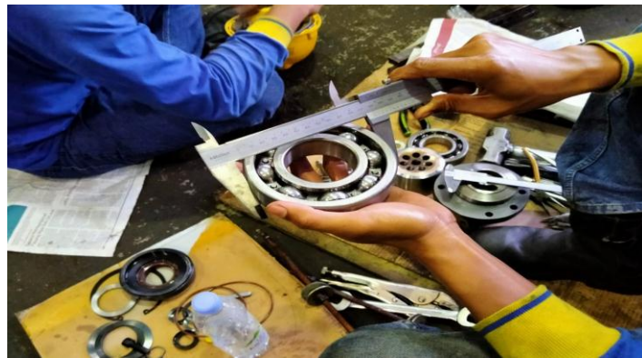
Gambar 1. Pengukuran diameter luar Bearing 1
