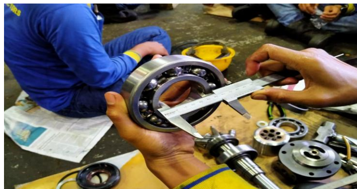
Gambar 2. Pengukuran diameter dalam Bearing 1
