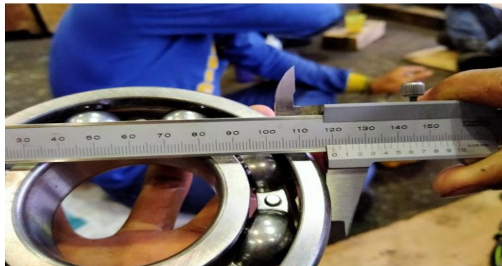
Gambar 3. Pengukuran diameter luar Bearing 2
