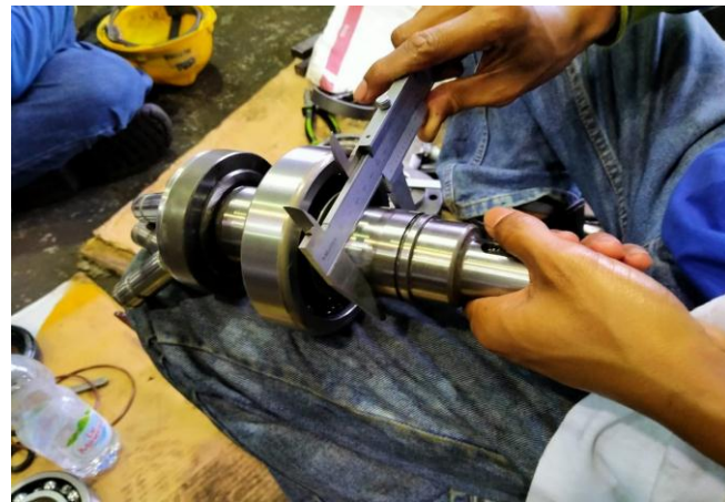
Gambar 5. Pengukuran Pada Shaft
